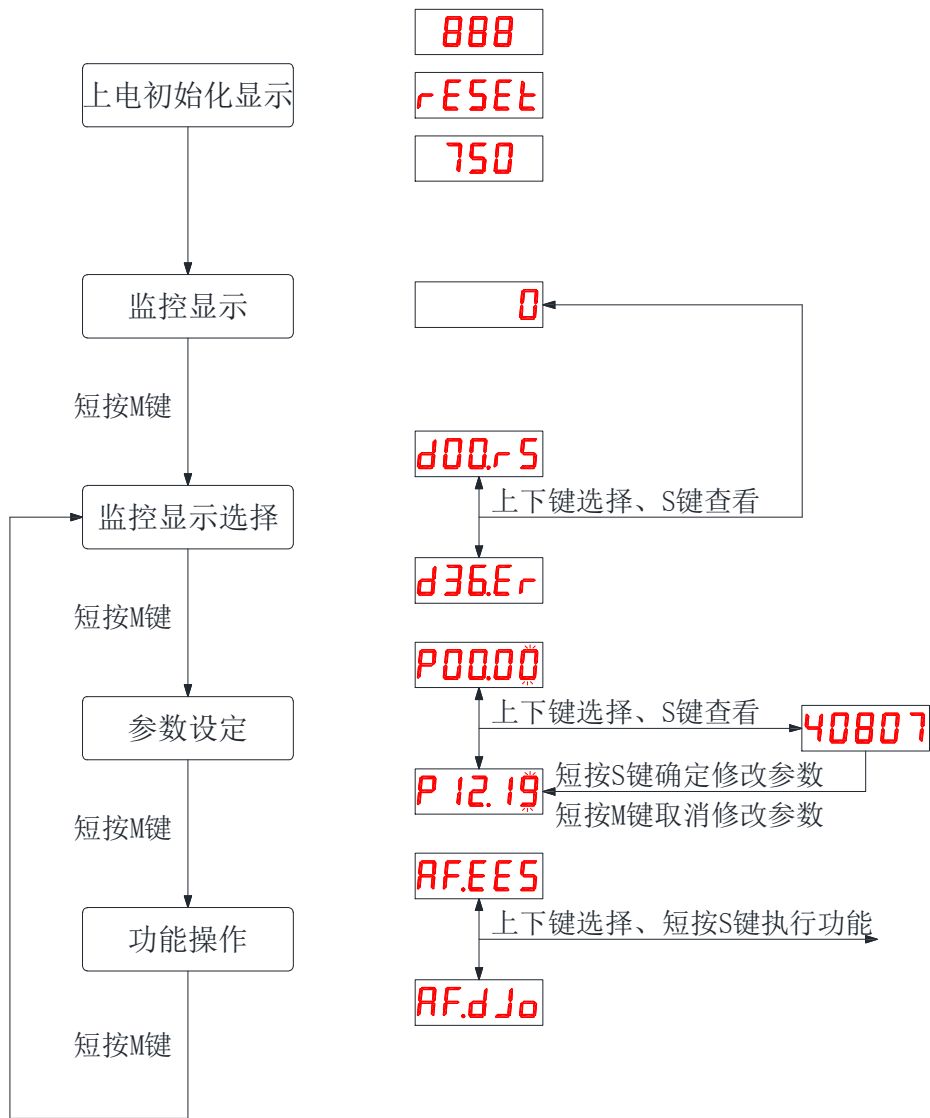
图 4-1 伺服驱动器面板操作示意图
